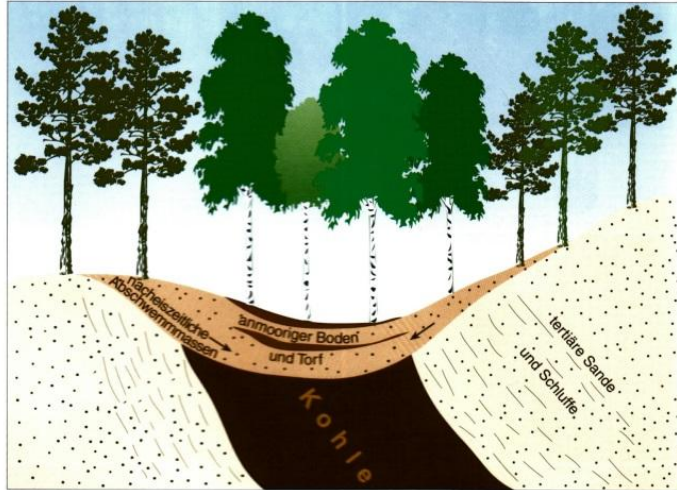
Abb. 70. Querschnitt durch einen Gieser, gezeichnet nach dem Aufschluss im Tagebaurestsee der Mulde VII bei Halbendorf (1921). – Entwurf: MANFRED KUPETZ, Grafik NORBERT ANSPACH.
